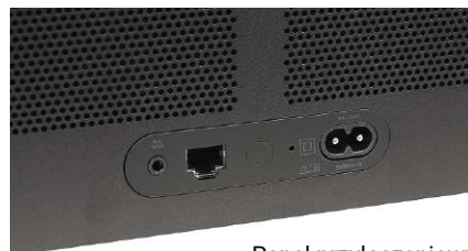
Panel przyłączeniowy umożliwia podłączenie do sieci LAN, jest też jedno wejście analogowe.
